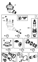
ETB-001127, Skrzynia biegów zewnętrzna mechaniczna (przełączana)
